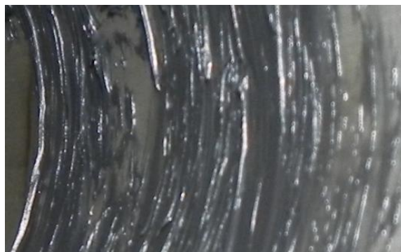
Рис.19. Вид ближе, датчики полностью покрыты слоем смазки
