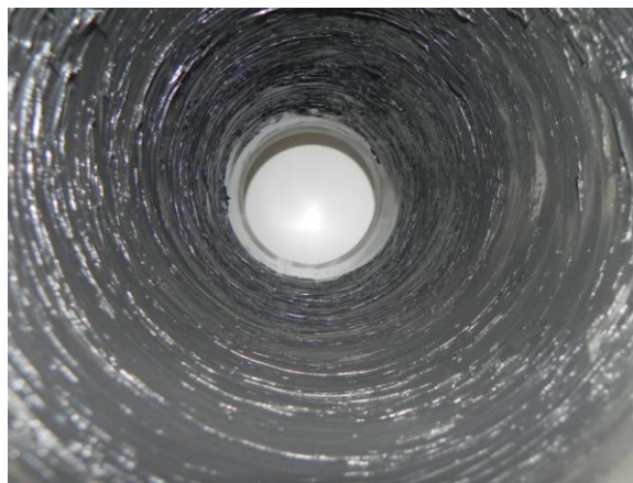
Рис. 18. Корпус расходомера, покрытого черной смазкой
